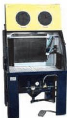
Камеры струйной очистки КСО-110-ИМ предназначены для очистки, снятия ржавчины, песка и окалины, шероховатости, снятия слоев, матирования, упрочнения, снятия заусенцев и полирования, а так же для подготовки поверхностей перед нанесением антикоррозионных покрытий (лакокрасочных материалов, металлизированных покрытий).
